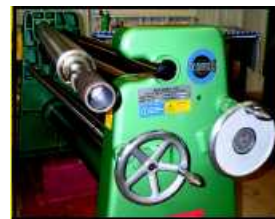
Rodillo superior en posición para extracción de la virola. (volante con indicador de posición, opcional).
